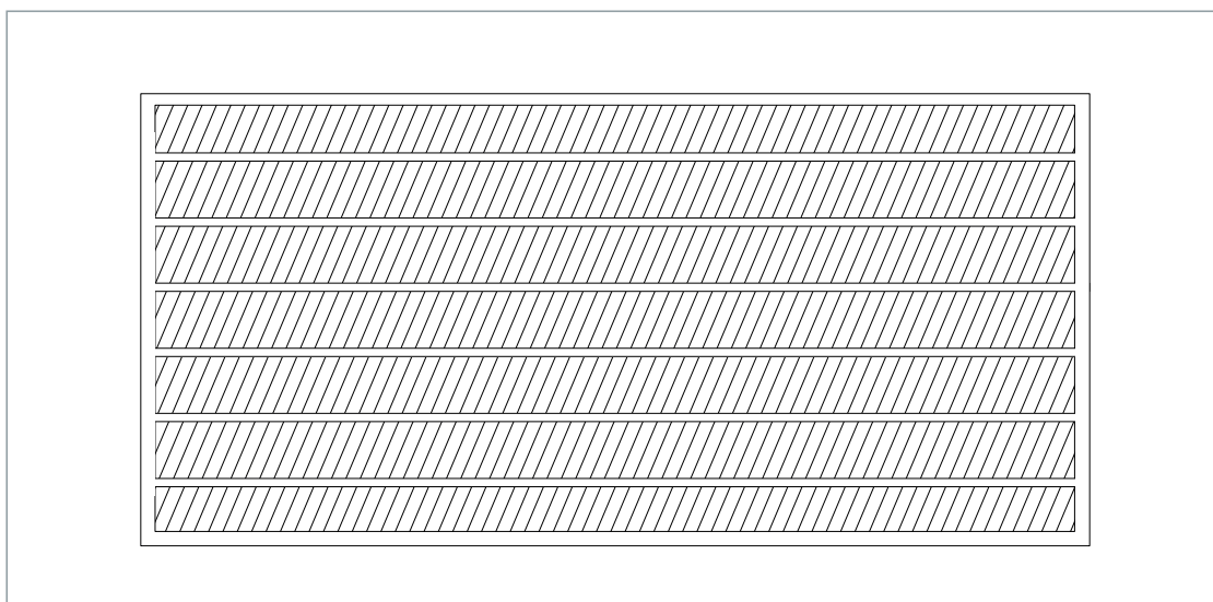
Rys 2. Sposób nałożenia zaprawy klejącej na płyty lamelowe z wełny mineralnej.
